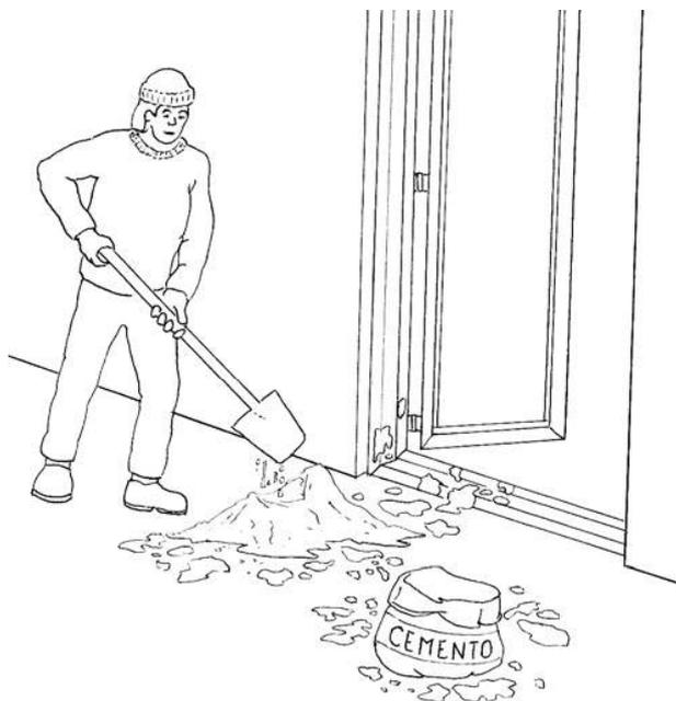
Questo perché il contatto in condizioni non idonee con la malta umida, con il gesso ed in generale con alcuni dei materiali utilizzati in edilizia, può causare danni ai profilati in Alluminio, quali ad esempio l'insorgere di gravi fenomeni di corrosione.
